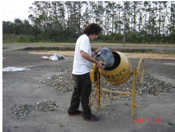
**Figura 06: Betoneira para homogeneização das composições**
